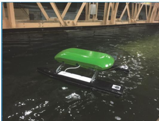
Рисунок 3 – Промерное судно
