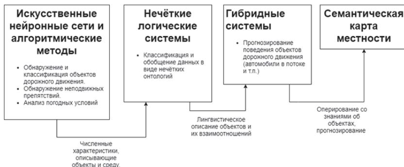
Рисунок 1 – Схема анализа дорожной обстановки
