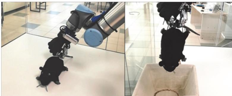
Рисунок 1 – Различные конфигурации антропоморфного захвата при манипуляциях с объектом
