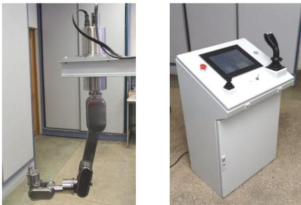
Рисунок 1 – Общий вид внутрикамерного манипулятора МР-48
