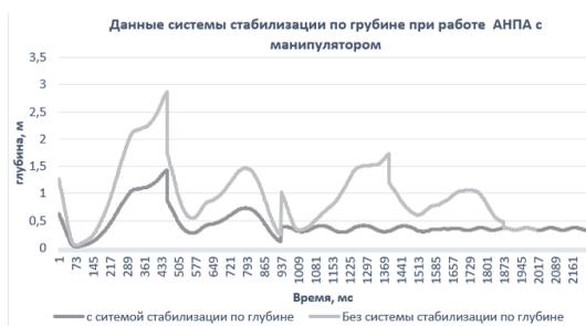
Рисунок 2 – Работа системы стабилизации глубины аппарата во время работы МК
