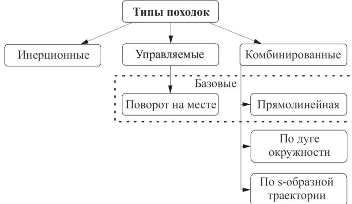
Рисунок 2 – Классификация походок двухзвенного ползающего робота
