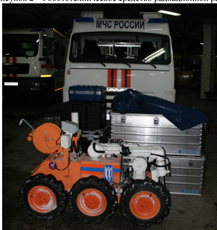
Рисунок 3 – Робототехническое средство радиационной разведки и проведения технологических операций
