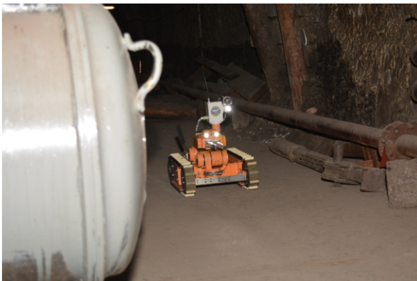
Рисунок 2 – Робототехническое средство радиационной разведки
