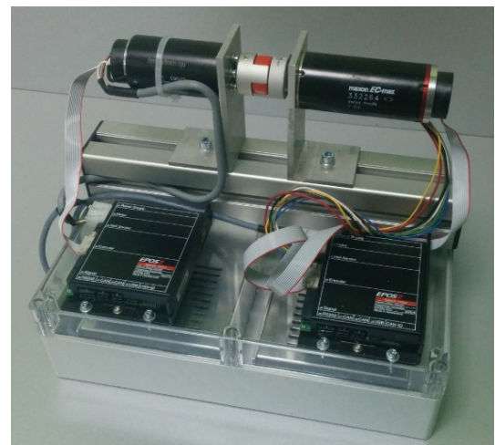
Рисунок 2 – Внешний вид универсального учебно-исследовательского стенда для имитации нагружения электродвигателя
