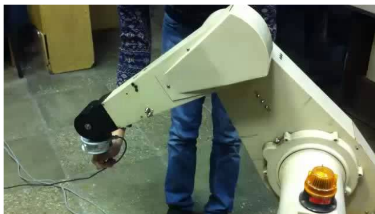
Рисунок 1 – Биомехатронный модуль на базе силового датчика ВС6W
