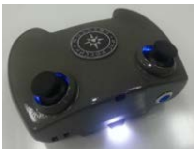
Рисунок 5 – Пульт управления ходовым макетом
