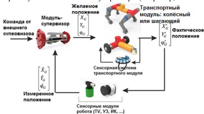
Рисунок 1 – Пример функциональной завершенности модулей
