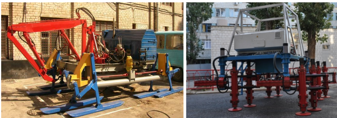
Рисунок 1 – Шагающие роботы Волгоградского государственного технического университета: а) шагающая машина «Восьминог», б) шагающий робот «Ортоног»
