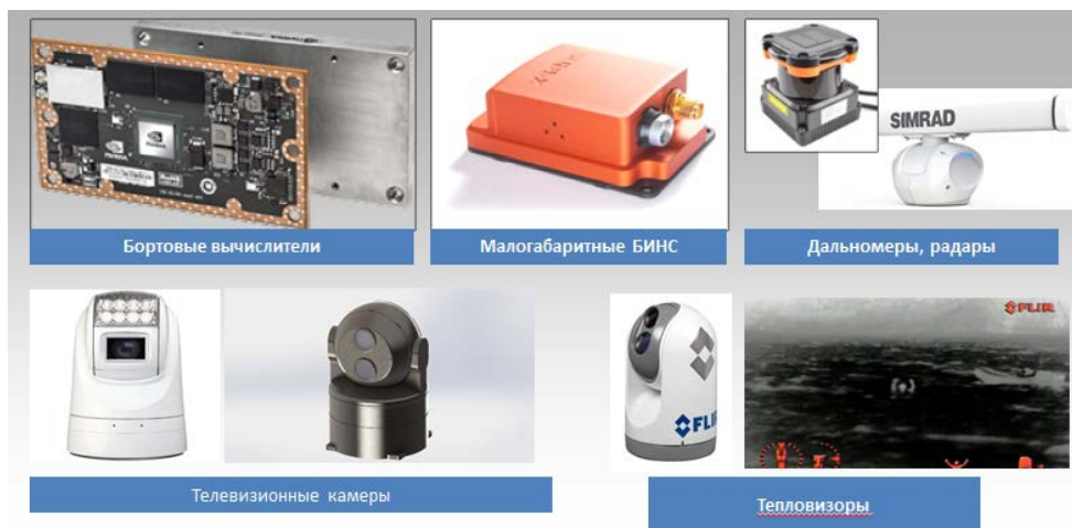
Рисунок 5 – Основные комплектующие составных частей БСУ для БП УСС
