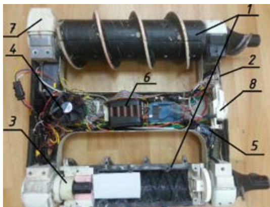
Рисунок 3 – Устройство ходового макета звена робототехнического средства
