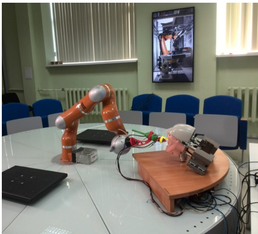
Рисунок 2 – Экспериментальный стенд роботической биопечати эмали in situ
