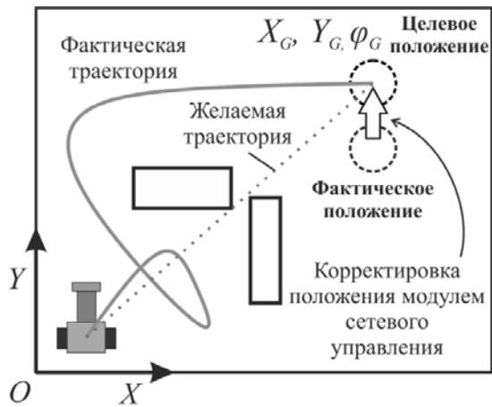
Рисунок 2а – Движение модульного робота в неизвестной среде
