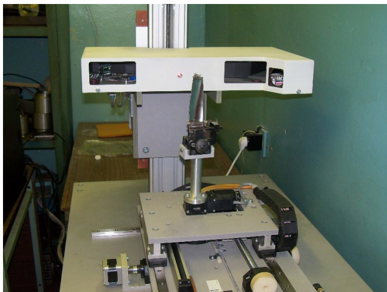
Рисунок 3 – Оптическая система контроля геометрических параметров пера лопаток
