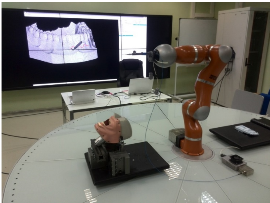
Рисунок 1 – Роботизированный multifunctional хирургический комплекс для лазерной челюстно-лицевой хирургии
