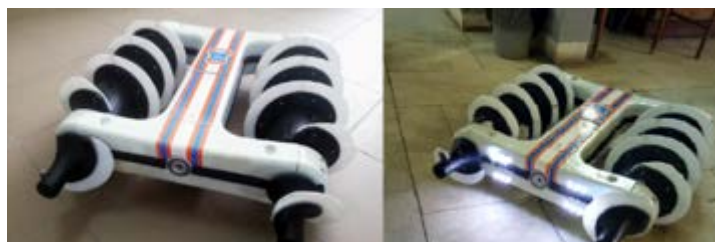
Рисунок 2 – Внешний вид ходового макета звена робототехнического средства
