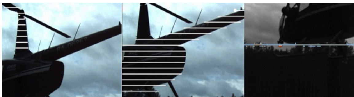
Рисунок 5 – Выделение сигнального огня вертолета на изображении высокого разрешения и сегментация частей вертолета
