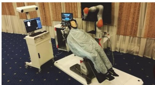
Рисунок 2 — Робототехническая система для разрезания мягких тканей
