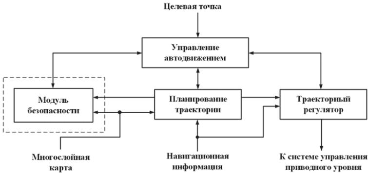
Рисунок 1 — Функциональная схема системы управления мобильного робота
