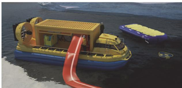
Рисунок 1 — 3D-модель СВП с оборудованием ЛАРН в контейнере
