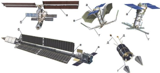
Рисунок 1 — Варианты применения крупногабаритных трансформируемых конструкций в составе КА: а – солнечные батареи; б – радиаторные фермы; в – антенны радиодиапазона; г – фермы и стержни для размещения массивов малогабаритной аппаратуры; д – штанги гравитационной стабилизации; е – фермы отодвижения для аппаратов с ядерным источником энергии (космических буксиров)
