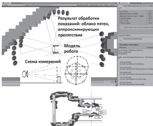
Рисунок 2 — Результаты работы двух алгоритмов пространственного сопоставления показаний ультразвуковых сенсоров — выполняется аппроксимация препятствий облаком пятен (вверху) или шлейфом из трапеций (внизу)
