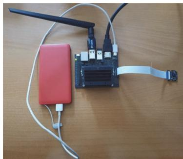
Рисунок 1 — Прототип системы телеметрии на базе NVIDIA Jetson Nano
