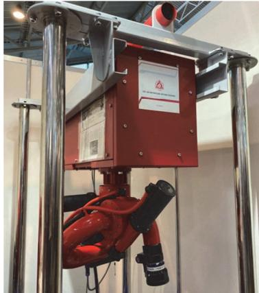
Рисунок 1 — Общий вид противопожарного комплекса на основе мобильных роботов АСС
