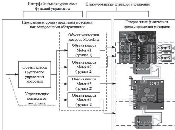
Рисунок 1 — Связь программных и физических объектов для группового управления четырьмя моторами постоянного тока, подключенных к различным типам драйверов двигателей
