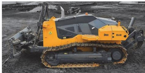
Рисунок 1 — Бульдозер без кабины
