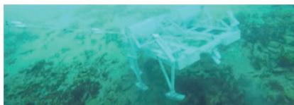
Рисунок 1 — Подводные испытания шагающего аппарата
