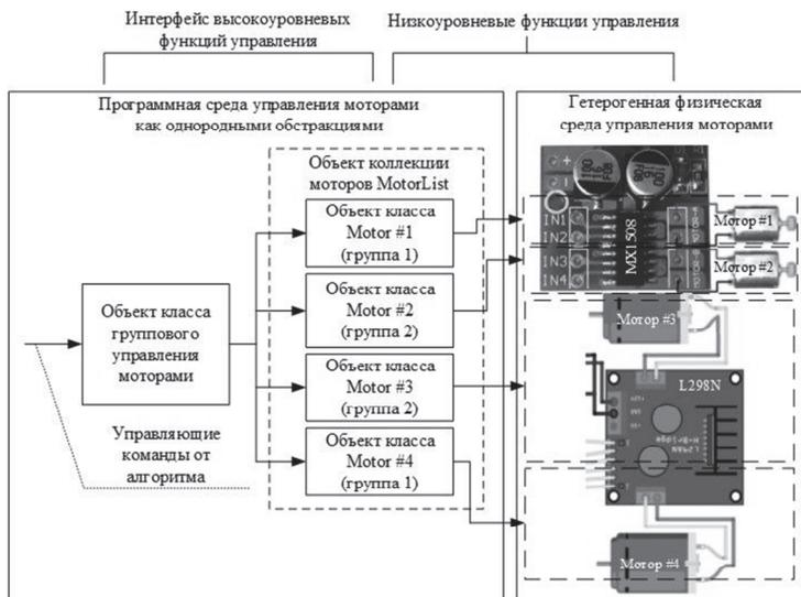
Рисунок 1 — Связь программных и физических объектов для группового управления четырьмя моторами постоянного тока, подключенных к разным типам драйверов двигателей
