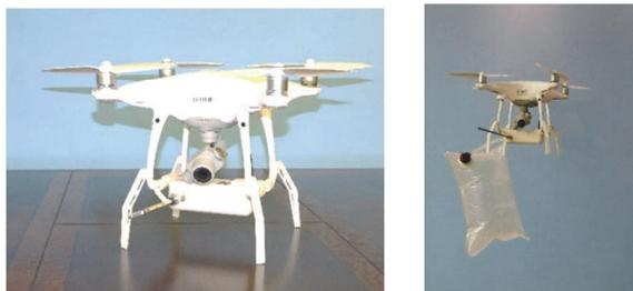
Рисунок 2 — Газоанализатор «Оса» с дополнительным устройством
