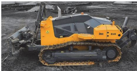
Рисунок 1 — Бульдозер без кабины
