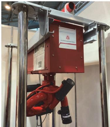
Рисунок 1 — Общий вид противопожарного комплекса на основе мобильных роботов АСС
