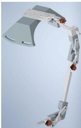
Рисунок 1 — 3D модель устройства, считывающего данные фактического положения руки
