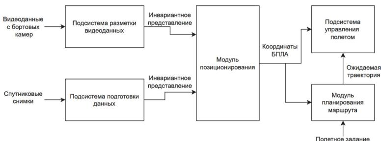
**Рисунок 1 — Архитектура системы видеонавигации БПЛА**
