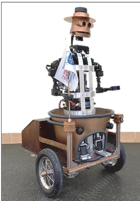
Рисунок 5 — Робот-экскурсовод Ментор-1
