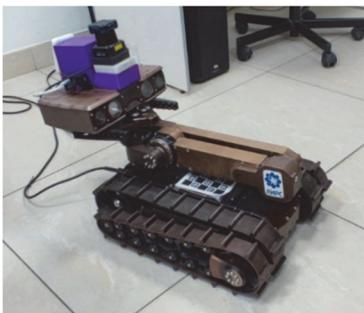
**Рисунок 1 — Мобильный робот «Сервосила Инженер»**
