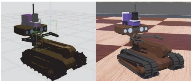
**Рисунок 2 — Виртуальная модель робота «Сервосила Инженер» в симуляторе Gazebo (слева [8]) и Webots (справа)**
