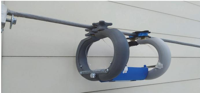
**Рисунок 1 — Проверка работоспособности робота на участке ВЛЭП**
