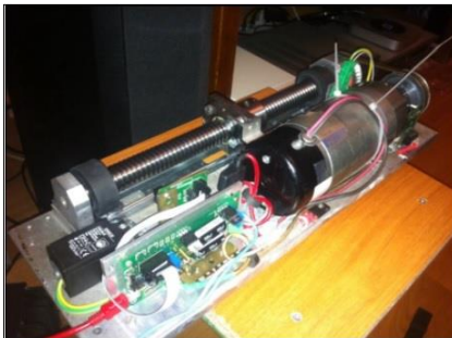
Рис 8. Приводы сцепления (тормоза) и руля в "АвтоНиве".
