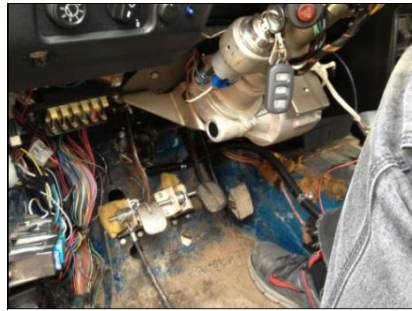
Рис 8. Приводы сцепления (тормоза) и руля в "АвтоНиве".
