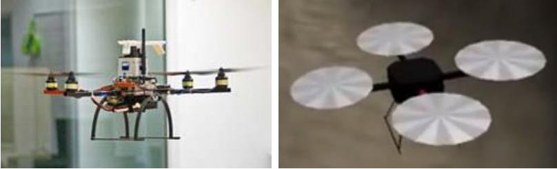
Рис. 2. Квадроторный БПЛА: фото (слева) и модель из Gazebo (справа).
