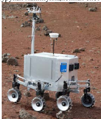
Рисунок 1 – Фрагмент ходовых испытаний макета Artemis на базе самоходного шасси с Т-образной рамой. Полигон Serom. M. Delpuch, ASTRA-2015
