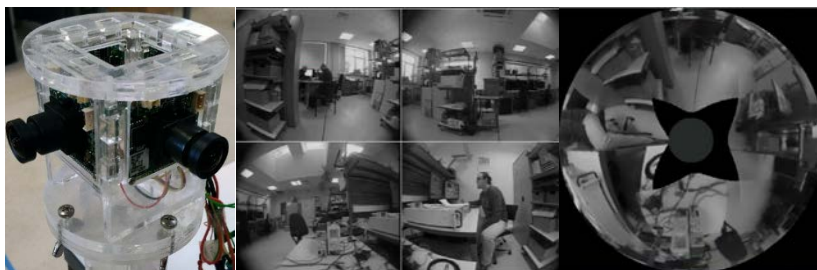
Рисунок 1 – Внешний вид разрабатываемого модуля (слева), входное изображение (в центре) и выходное изображение (справа)
