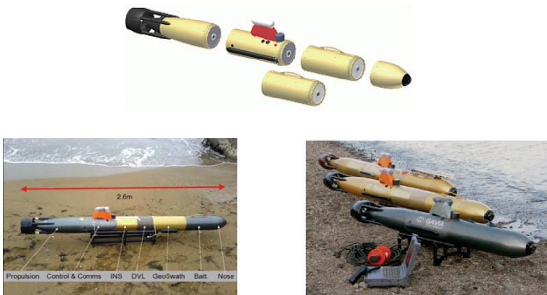
Рис. 7. Модульная конструкция МПР
