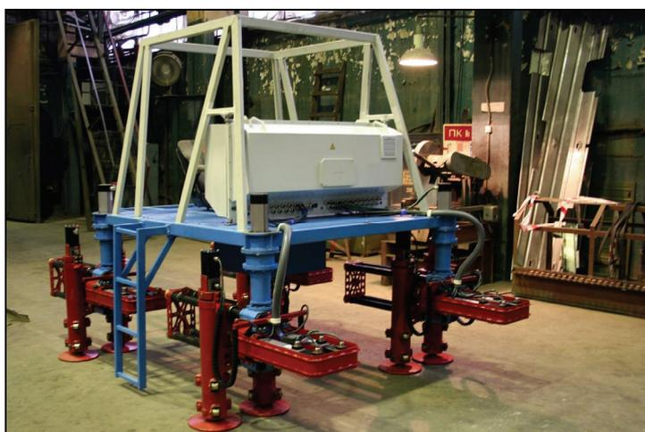
Рис.17. Шагающая машина "Ортоног". Волгоград
