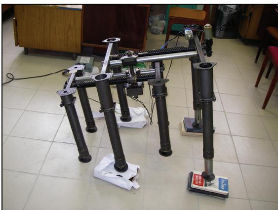
Рис.16. Робот с ортогонально-поворотным движителем. ВолгГТУ. Волгоград
