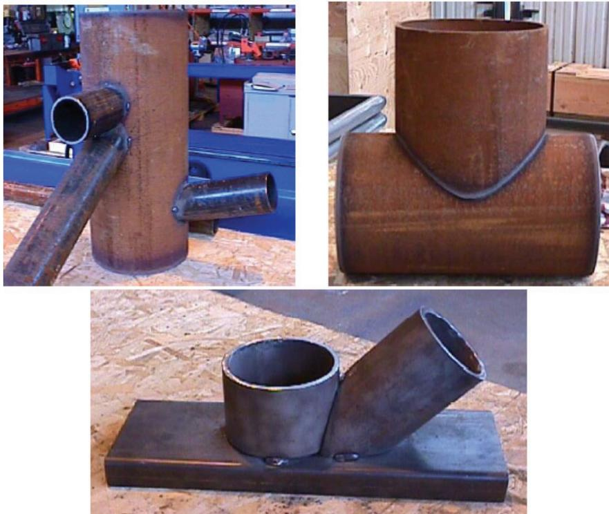
Рис. 8. Соединения трубопроводов, изготавливаемые с использованием промышленных роботов
