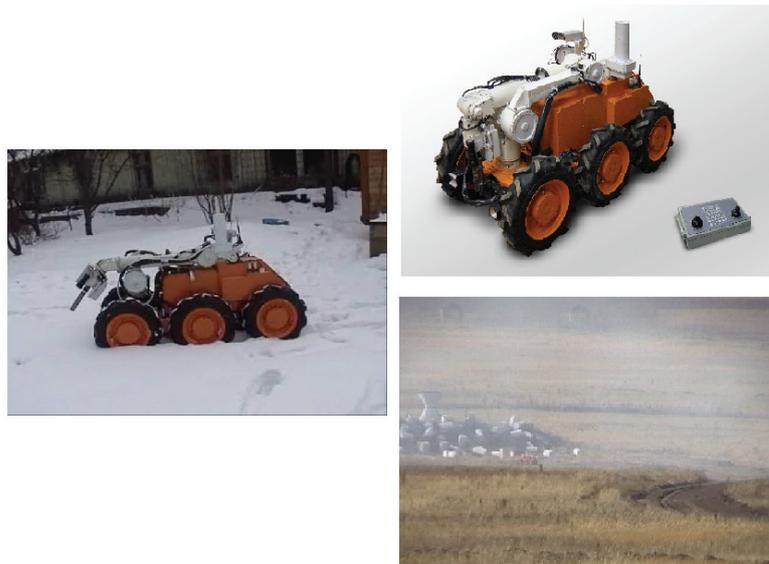
Рис. 5. Дистанционно управляемый мобильный робот радиационной и химической разведки ДР РХР
