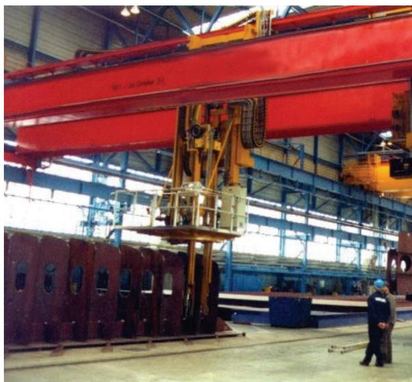
Рис. 5. Роботизированный комплекс для изготовления двойных бортов
