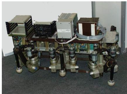
Рис.5. Шагающий робот ИПМ им. М.В. Келдыша РАН. Фотографии 2009 г.
